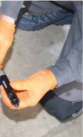
Bremsleitungen aus Kunifer kann der Monteur problemlos direkt unter dem Fahrzeug anfertigen.
