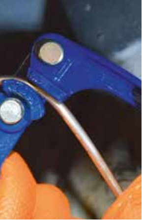
Mit einem Biege- werkzeug fertigt der Monteur optisch schöne Biegungen, ohne das Material zu schwächen.
